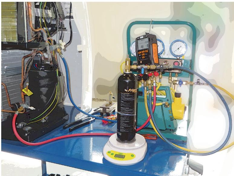
FIGURE 21 Préparation à la charge suite au tirage au vide de l'installation (-1 Pa sur le manomètre)
