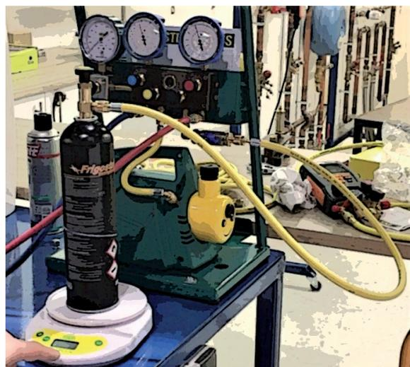
FIGURE 22 Procédure de charge au R290
