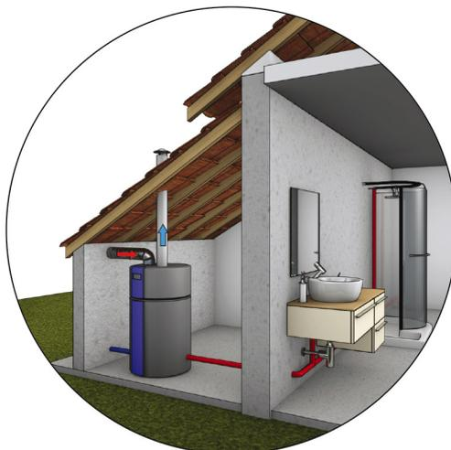
**FIGURE 16** Exemple de chauffe-eau thermodynamique raccordé sur l'air extérieur par des conduits aérauliques
