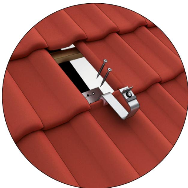
Exemple de pose de crochet dans le courant du fil d'eau
