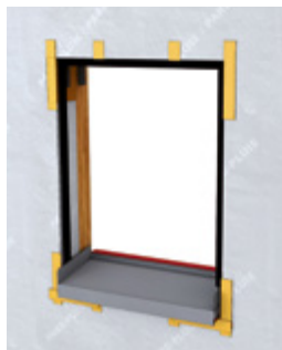
Calfeutrement en mousse imprégnée
