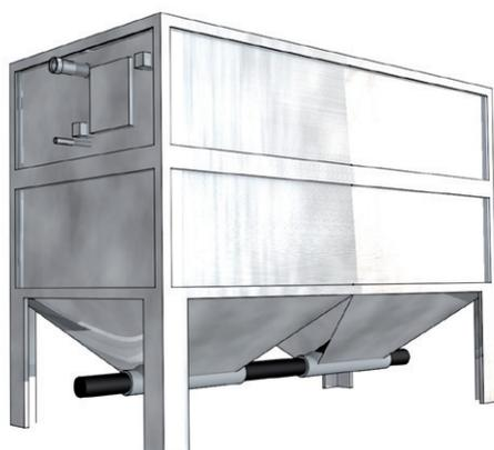
FIGURE 6 Illustration d'un silo préfabriqué métallique
