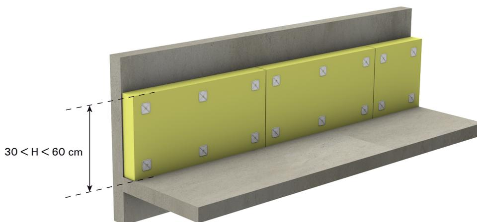
▲ Figure 5 : Panneau isolant en relevé :  $30 < \text{hauteur} < 60$  cm. Deux lignes horizontales de fixation par panneau de hauteur comprise entre 30 et 60 cm
