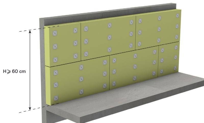
▲ Figure 6 : Panneau isolant en relevé, hauteur  $\geq 60$  cm. Trois lignes horizontales de fixation par rangée de panneau
