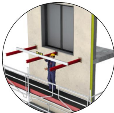
Vérifications de la planéité des poutres et des entraxes en bout des poutres
