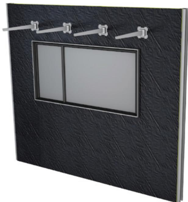
Le métallier doit vérifier la planéité des poutres et l'entraxe entre celles-ci après la pose de l'ITE et le calfeutrement.
