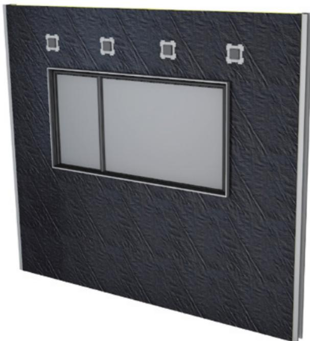
Selon le moyen utilisé, la reconstitution de l'étanchéité à l'eau peut être réalisée par l'utilisation de mastic ou de joint élastomère.
