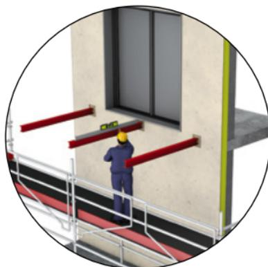
Avec rupteur thermique, le bon fonctionnement du système requiert une bonne étanchéité à l'air. Un bon calfeutrement entre l'isolant de la façade et le rupteur est nécessaire.
