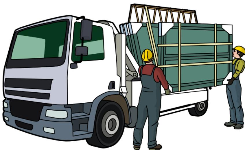
Les fenêtres doivent être protégées contre les chocs durant le transport par des moyens tels que bracelets, sangles, couvertures, et cales. Elles doivent être arrimées lors des transports.
