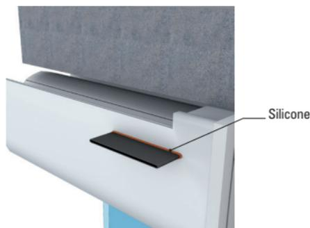
Réaliser l'étanchéité périphérique du manchon au mastic silicone. Caler le manchon jusqu'au séchage du mastic.
