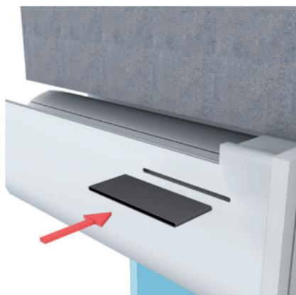
Insérer le manchon de traversée de doublage dans l'ouverture étagée de la paroi étanche. Manchon adapté à l'épaisseur du doublage.
