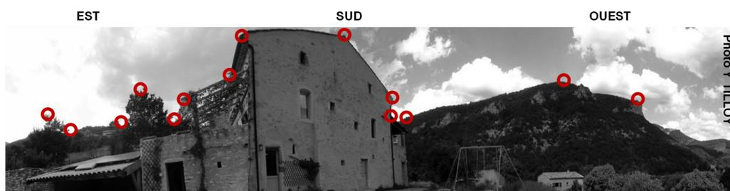
▲ Figure 12 : Relevé des masques depuis l'emplacement prévu pour les capteurs
