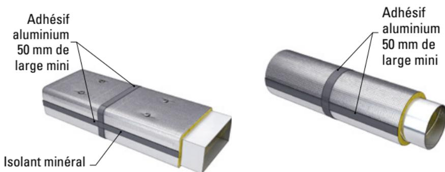
! Pour les conduits rectangulaires dont un côté est de dimension supérieure à 600 mm, un complément de maintien est à prévoir,
