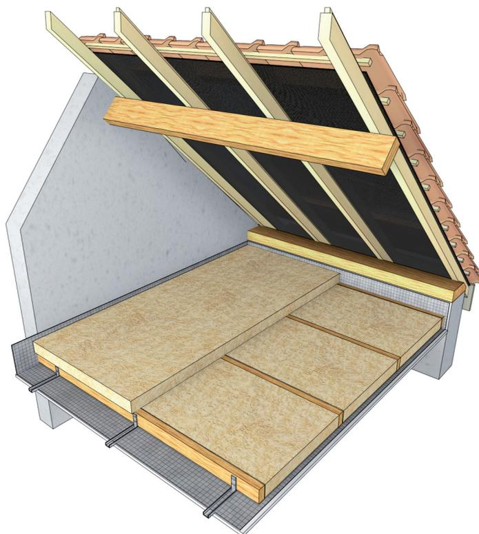
▲ Figure 61 : Isolation en combles perdus sur plafond : cas des charpentes traditionnelles
