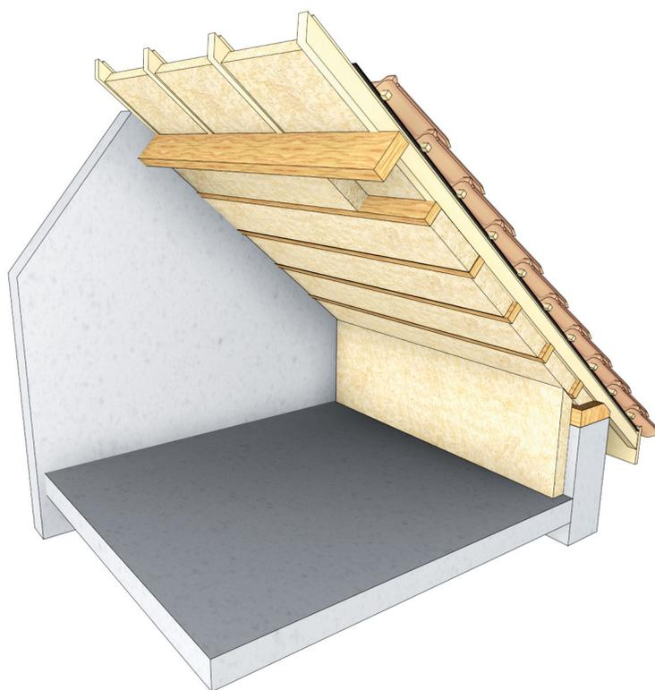
▲ **Figure 67** : Isolation thermique de rampant et pied-droit en combles aménagés, charpente traditionnelle, parement non représenté, sur ossature bois
