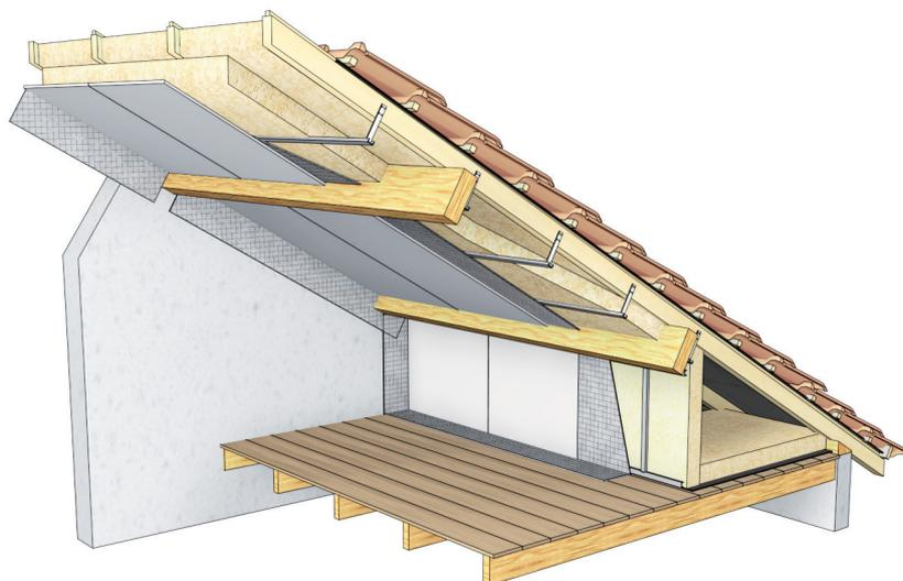
▲ Figure 68 : Isolation thermique de rampant et pied-droit en combles aménagés, charpente traditionnelle et plancher bois, parement sur ossature acier
