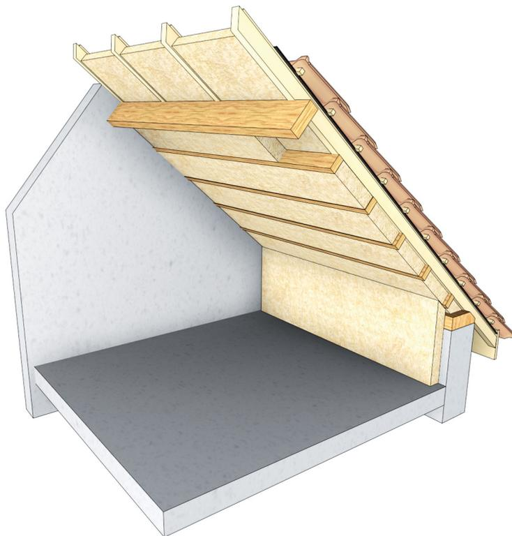
▲ Figure 12 : Isolation thermique de rampant et pied-droit en combles aménagés, charpente traditionnelle, parement non représenté, sur ossature bois
