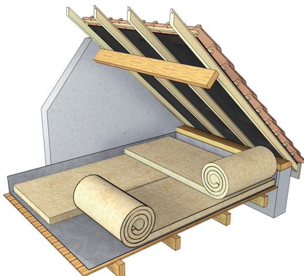
▲ Figure 60 : Isolation en combles perdus sur plancher bois
