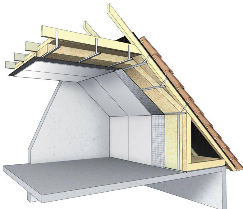
▲ Figure 69 : Isolation thermique de rampant et pied-droit en combles aménagés, fermettes industrielles en A, parement sur ossature acier (représentation avec plancher béton)
