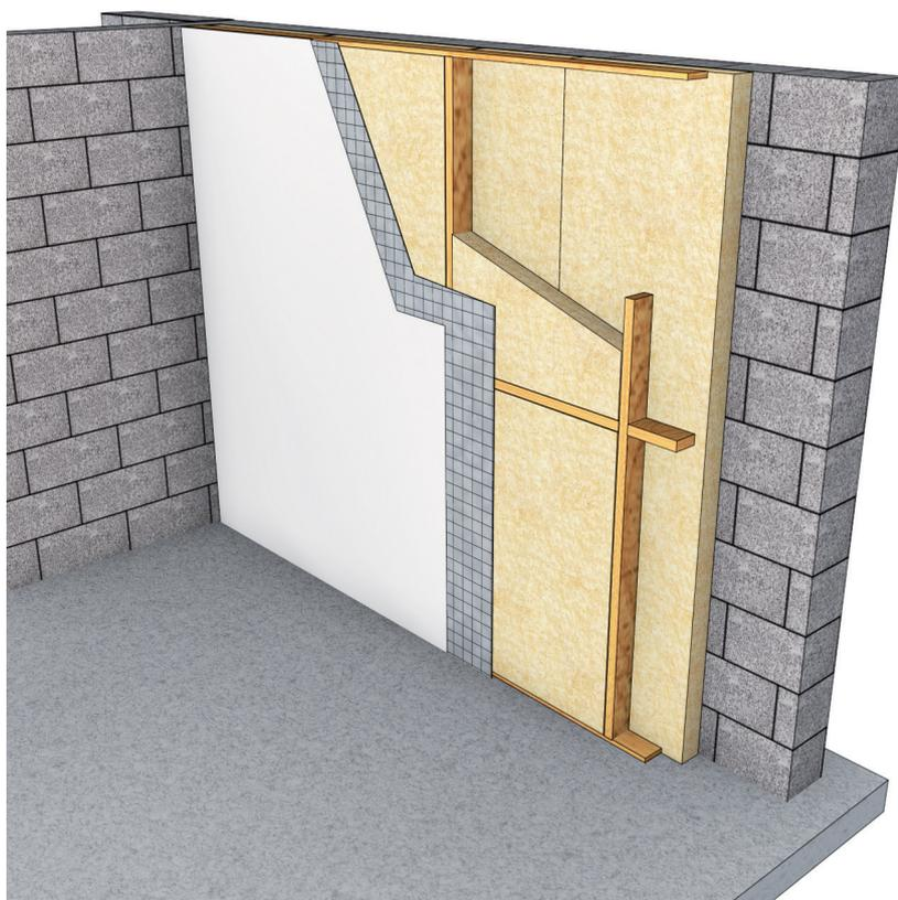
▲ Figure 86 : Contre-cloison en plaques de plâtre sur ossature bois avec deux couches d'isolant, l'une derrière l'ossature et l'autre entre les ossatures
