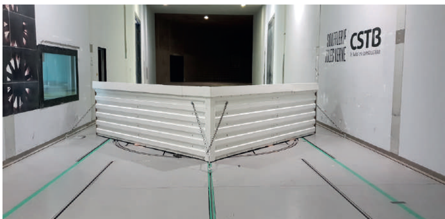
FIGURE 1 Orientation des maquettes pour les essais à la ruine
