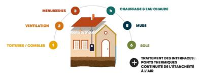
Figure B: schéma des 6 postes de travaux nécessaires à la performance thermique (source: Dorémi)
