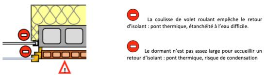
Figure 25 : ITE interrompue par un volet roulant existant (source : Dorémi)
