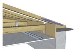
Figure 32 : Mise en place de déflecteurs. Source : CPT 3693 (CSTB)
