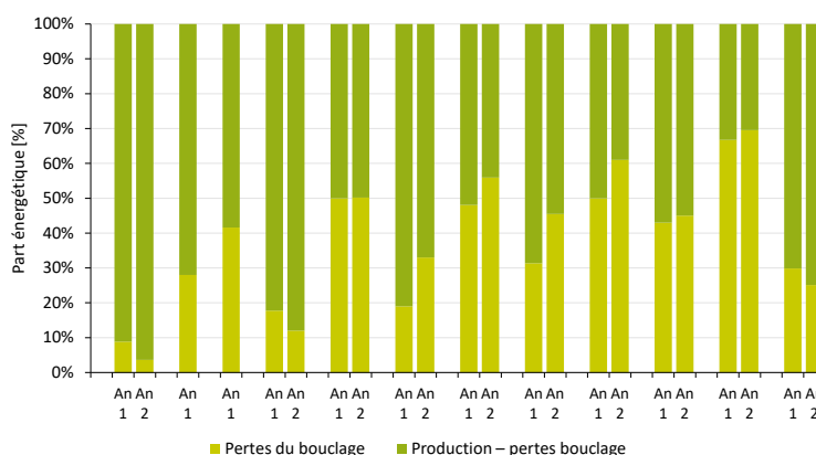
Illustration 10 - Les pertes énergétiques liées au bouclage sanitaire dans des bâtiments d'habitation sont à l'origine de plus de 20 % des consommations.
