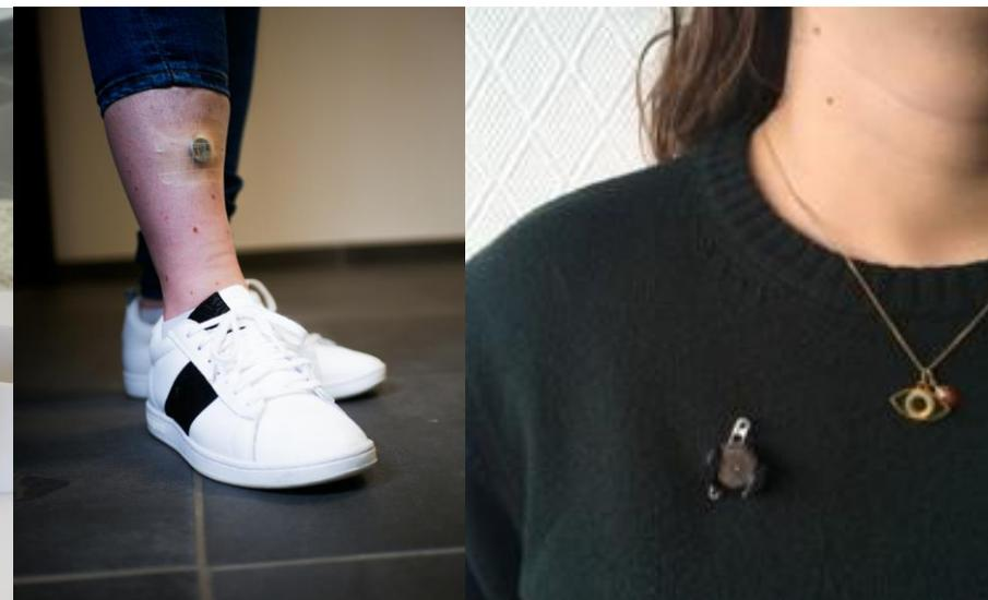
**Mesures environnementales embarquées sur l'occupant : humidité, température radiante et d'air au voisinage du sujet**
